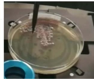
Prélèvement des colonies et préparation automatique de la suspension microbienne
